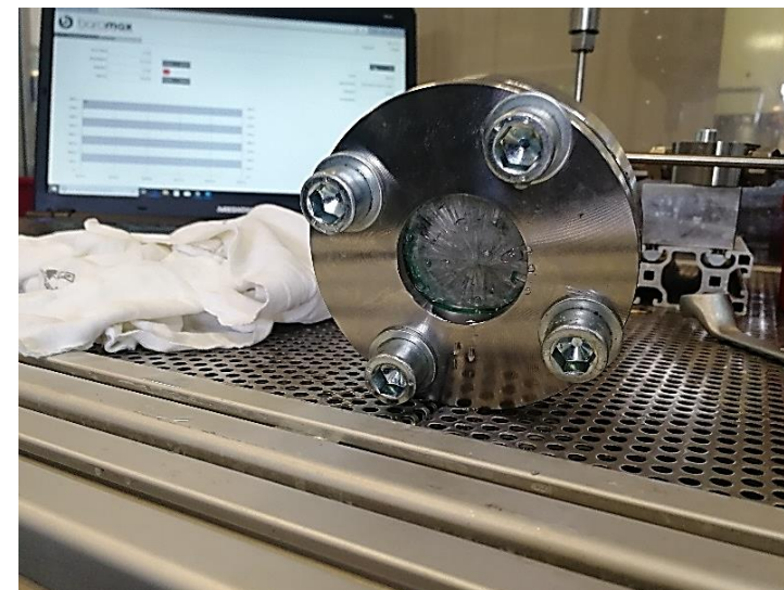
Berstprüfung an Sichtglas in einer von baromax eigens entwickelten Vorrichtung
